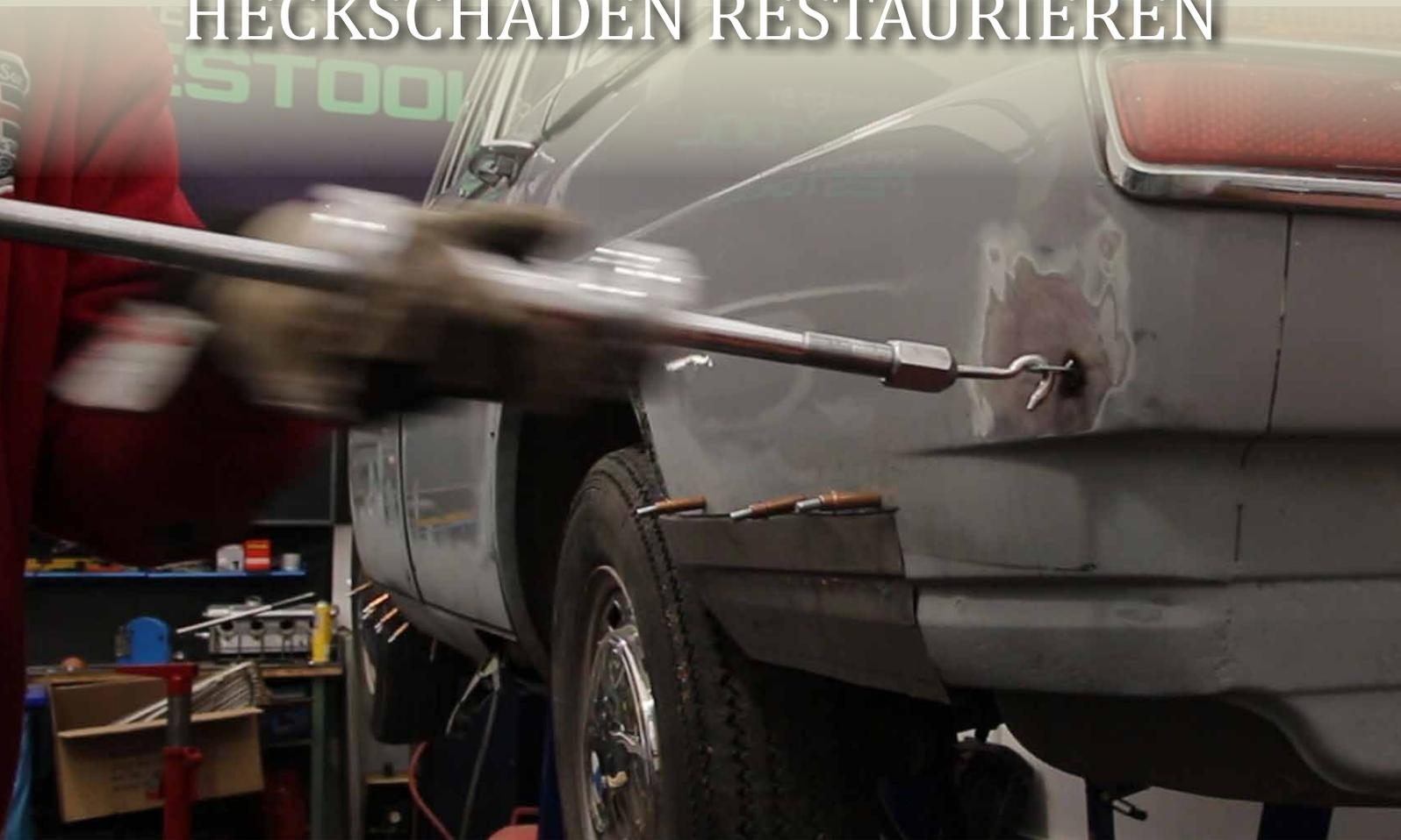
Am Heck des BMWs hat sich genau an der Ecke des unteren Kofferraums am seitlichen Kotflügel eine Delle gebildet. Die Stelle ist so steif, dass man mit reinem sanften Delnziehen nicht weiter kommt. Hier hilft nur das Umformen des Blechs mit einem Gleithammer und aufgeschweißten Zugpunkten.
